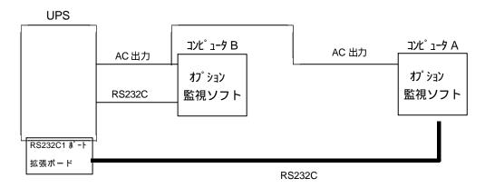
基本的な動作上図のシステム構成例のように、本基板を組み込むことで、弊社のオプション監視ソフトをインストールしたコンピュータ A,B から UPS を監視することができます。 1 台の UPS で 2 台のコンピュータを接続することが可能となります。 UPS の情報(停電、バッテリ残量等)の取得、UPS の AC 出力を停止、起動が行えます。コンピュータをシャットダウンしてから UPS の AC 出力を停止することも可能です。
