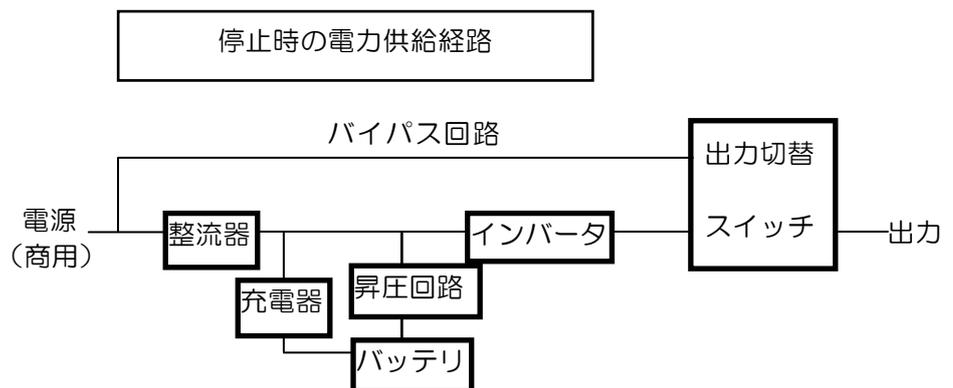
(3) 停電／過電圧・復電時動作
