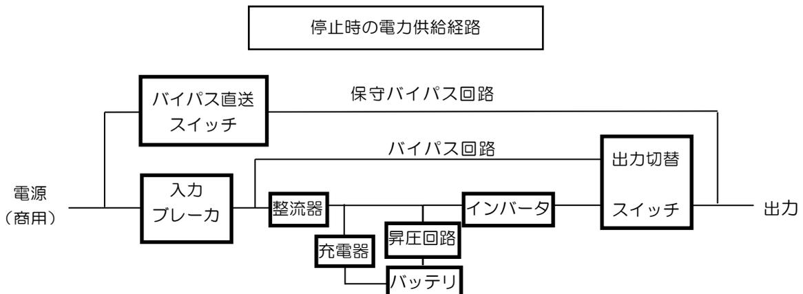
(3) 停電／過電圧・復電時動作
