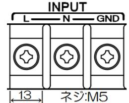
分電盤から UPS までの距離が長い場合は、電圧降下が無いように十分電流容量の大きな電線を使用してください。
