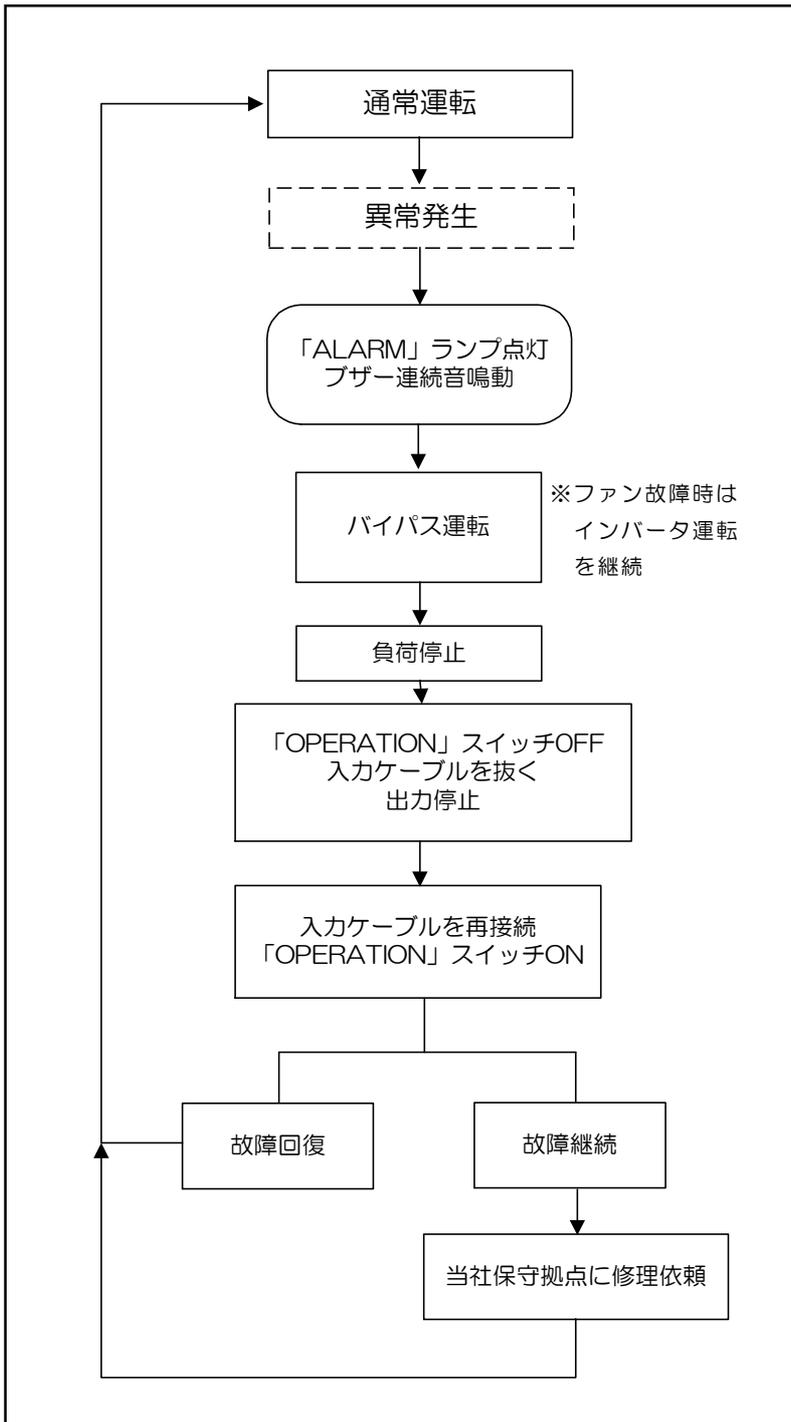
(1) 以下のような重故障が発生した場合、「ALARM」ランプが点灯し、ブザーが連続鳴動します。また、商用直送給電（バイパス運転）に切り替わります。
