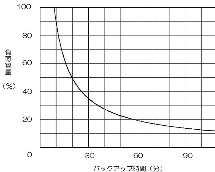
上記のバックアップ時間は 20℃、初期状態の値です。バックアップ時間は使用年数および放電回数により変化します。目安として、寿命末期時は初期状態のバックアップ時間の約半分となります。
