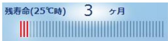
FeliSafe Pro 起動時、および起動後 24 時間毎、UPS との通信回線が再接続した際に計算を行い、警告や異常がある場合はそれぞれ「バッテリー寿命警告」イベント、「バッテリー交換」イベントを発行します。
