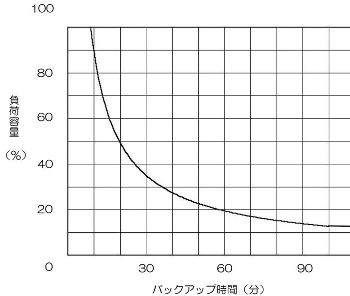
上記のバックアップ時間は 20℃、初期状態の値です。バックアップ時間は使用年数および放電回数により変化します。目安として、寿命末期時は初期状態のバックアップ時間の約半分となります。
