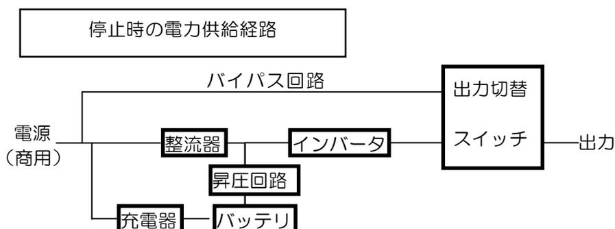
③ 停電／過電圧・復電時動作
